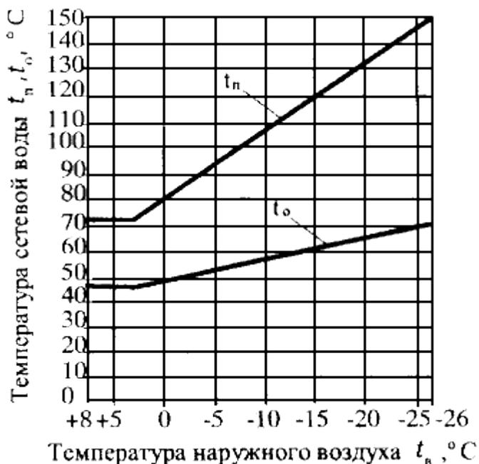
**Рис.1. Эксплуатационный температурный график регулирования отпуска тепла в тепловой сети:**
