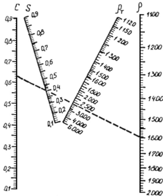
Рис.1.1. Номограмма для определения объемной  $S$  и массовой  $C$  концентрации твердого в зависимости от плотности гидросмеси и твердого
