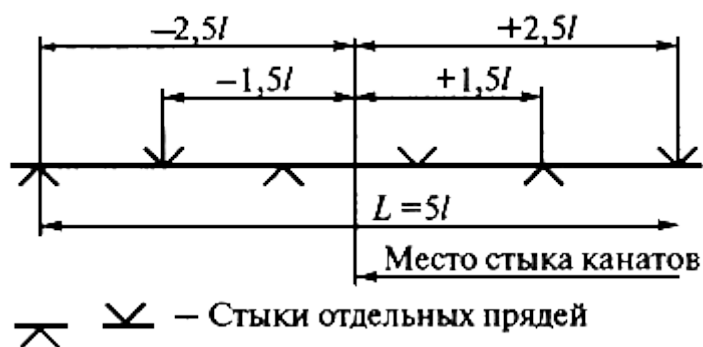
Рис.46. Схема счалки канатов:
