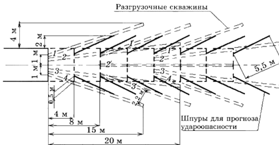
Рис.9.7. Схема заложения разгрузочных скважин и шпуров для прогноза удароопасности:
