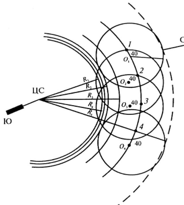
Рис.6. Схема построения нормальных сечений по замораживающим скважинам
