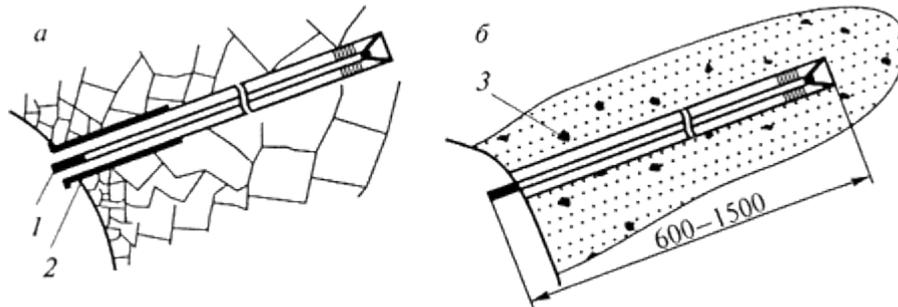
Рис.4. Анкеры распорного типа для закрепления маркшейдерских пунктов:
